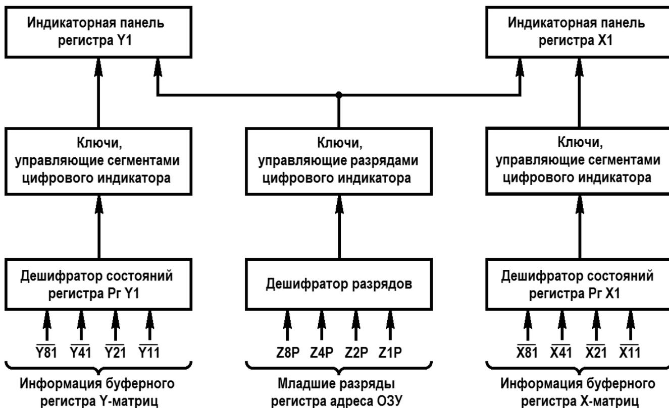
Рис. 22. Структурная схема блока индикации.
